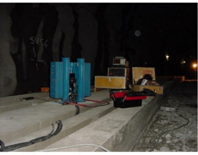
Bild 4. Hydraulexciter under montering
